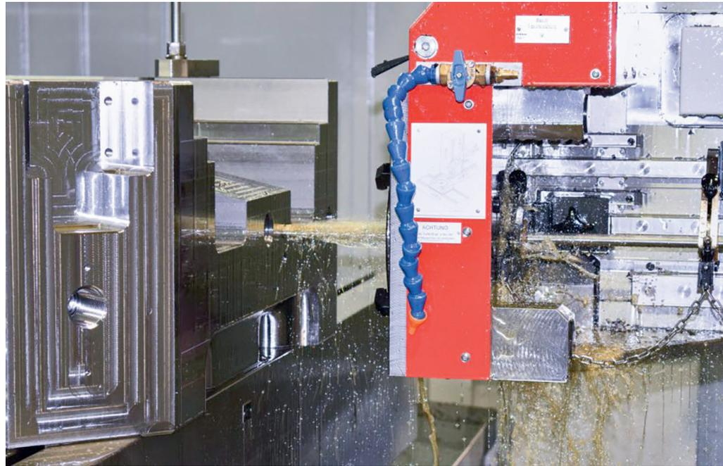
**Reibungslose Prozessabläufe:** Dafür sorgen die Werkzeugüberwachung, die Kühlmittel- und Kühlmittelzuflusskontrolle sowie der Späneförderer. © Samag
